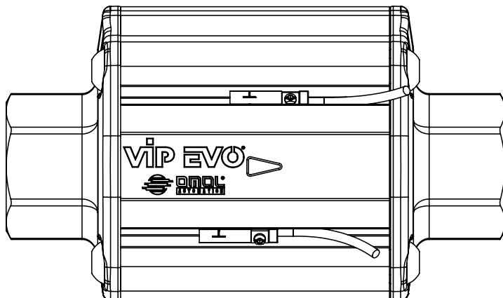
VIP EVO è predisposto per l'utilizzo di finecorsa induttivi a contatto magnetico, con led di segnalazione, i quali vengono forniti con un kit che ne consente un rapido fissaggio nelle scanalature laterali del corpo. I magneti per la rilevazione della posizione tramite finecorsa si trovano all'interno, di conseguenza si possono installare solamente durante l'assemblaggio di VIP EVO e non in fase successiva. Per questo motivo è necessario **specificare in fase d'ordine la richiesta del magnete**.
