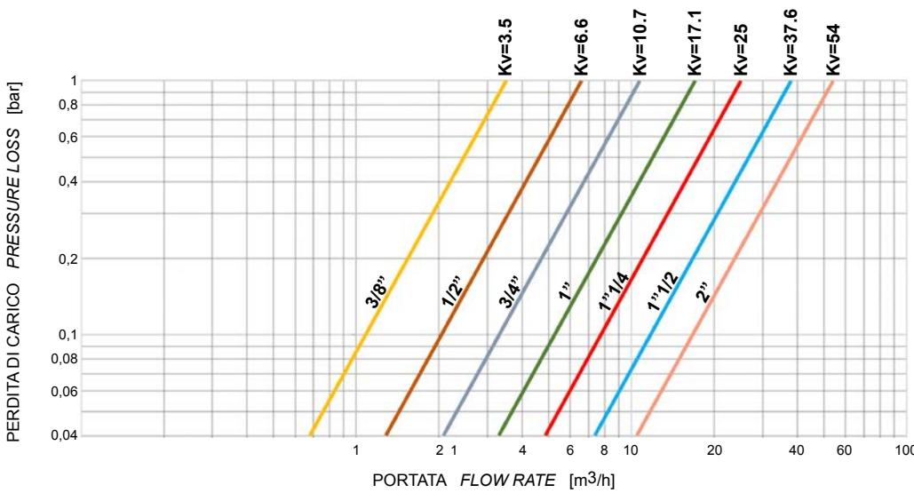
Il valore Kv è il valore di portata in m<sup>3</sup>/h (con acqua a 15°C) provocante la caduta di pressione di 1 bar.
